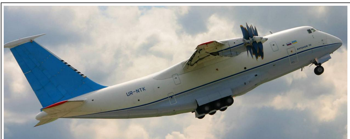
Рис. 5. Самолет Ан-70 с винтовентиляторными двигателями
